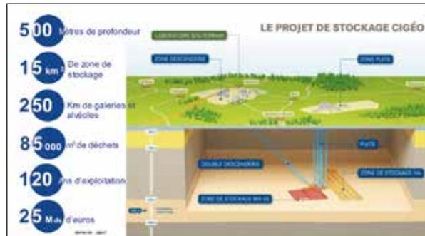
Le stockage géologique pour les déchets à haute activité et à vie longue (HAVL) se fera dans des couches d'argile à 500 m de profondeur
